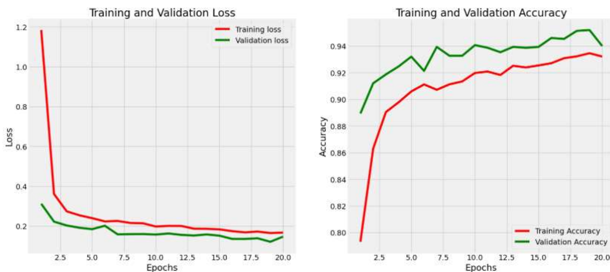
Figure 75 : Courbes d'évolution de la perte et de l'exactitude du modèle DenseNet121 sur les données d'entraînement et de validation.
